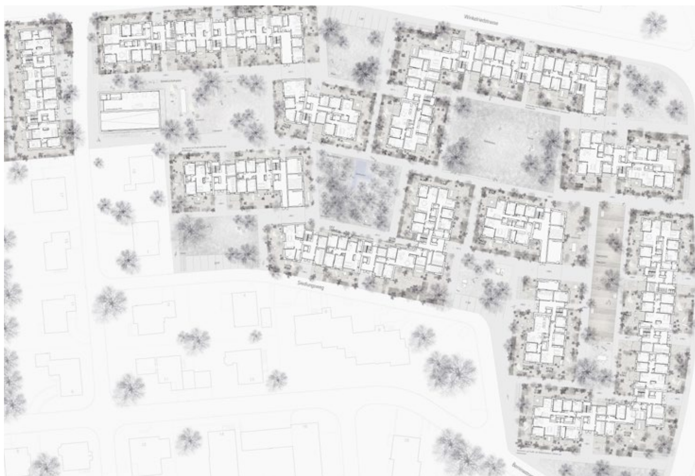
Die Hofräume sind jeweils direkt vom Eingangsbereich erschlossen. Erdgeschosswohnungen haben ihren eigenen Gartensitzplatz
